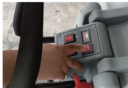
第3步:打开电源总开关,启动刷盘开关按钮、吸水电机开关按钮;
